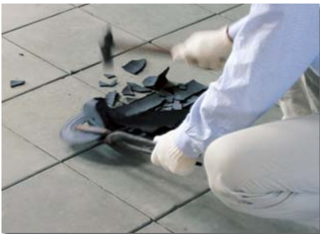
図2 復元銅鐸を750℃で約5分間加熱した後に金槌でたたく。いとも簡単に粉々に碎けた。
