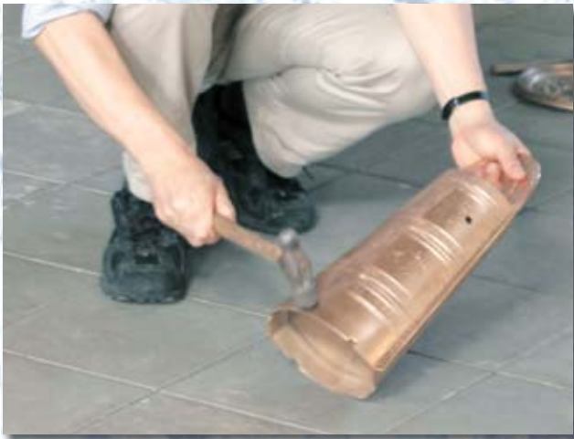
図1 復元銅鐸を加熱せずに金槌でたたく。へこむだけで碎けることはない。
